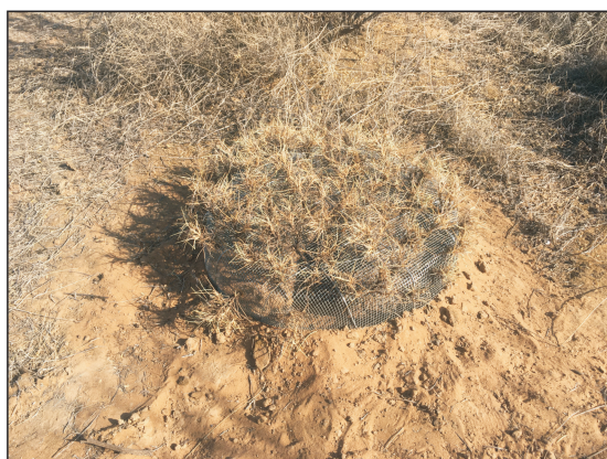
c 顶部四周均胶粘猫头刺茎叶的完整大、小模型
